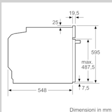
Montaggio con un piano di cottura.
