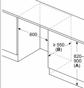
A: Altezza sottostruttura
