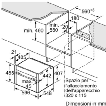
Montaggio con un piano di cottura.
